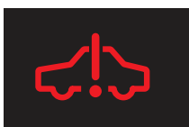
ハイブリッドシステム 異常警告灯
